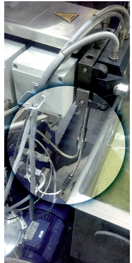
Bild 3. Der selbstüberwachende Massedrucksensor (im Kreis) schaltet den Extruder bei Erreichen eines kritischen Drucks ab (© Clariant)
